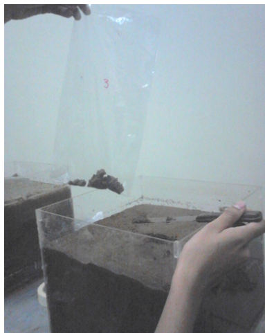
Figura 5 Coleta da amostra de solo, após a infiltração hídrica
